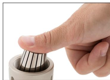
**Важно:** Не вставляйте цангу параллельно съёмному кольцу. Можно отколоть или сломать выжимные зубья. При разжимании гайки цанга сама выйдет из патрона благодаря выжимным зубьям.
